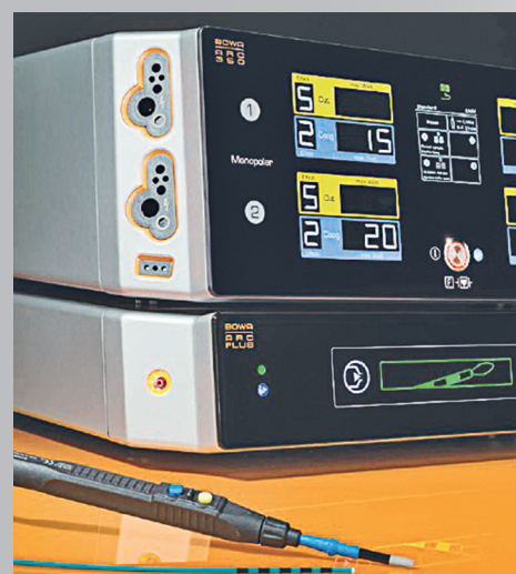
Рис. 5. Высокочастотный электрохирургический аппарат BOWA – монополярный коагулятор (Германия)
